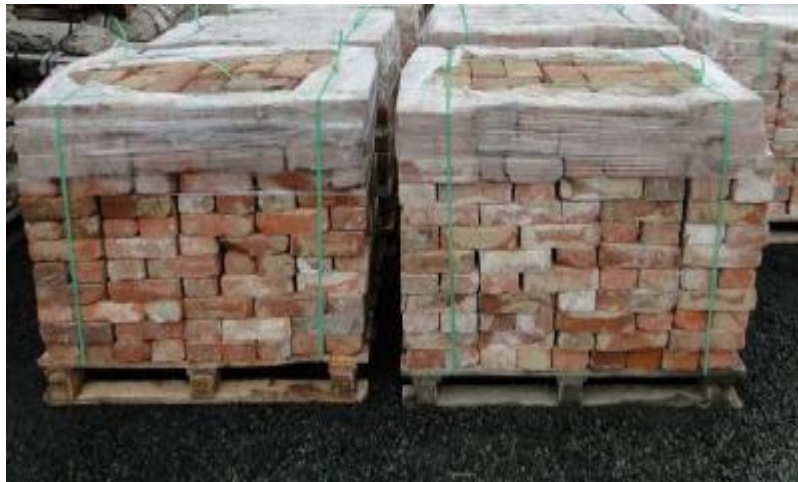
Abbildung 1-11 palettieren der Ziegel (hier: Vollziegel 1-2-4)
